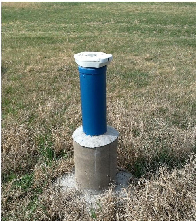
12. ábra: Jellemző kútfejkialakítás a monitoring kutak esetében
